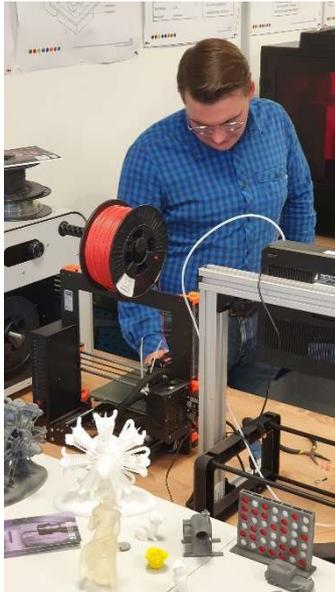
3D-Druck ist nicht nur die Bedienung eines Druckers, sondern das Verständnis des gesamten Prozesses, vom CAD-Design bis zur Nachbearbeitung. Auch die theoretischen Grundlagen gehören zum Handwerkszeug der 3D-Druckbediener, so auch das Wissen um den Gegensatz zwischen abtragenden Prozessen (Fräsen, Drehen, Sägen) und formativen Prozessen (Schmieden, Umformen, Pressen).
