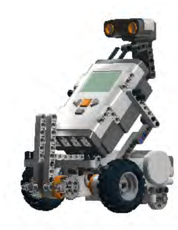
Abbildung 6.45: Lego NXT Roboter mit Ultraschallsensor.
