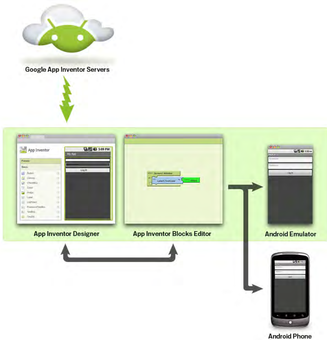
Abbildung 4.1: Der AppInventor aus der Entwickler-Sicht: Das Zusammenspiel von AppInventor Server, Webbrowser und Mobile Device (Quelle: oben angef. Internetseite).
