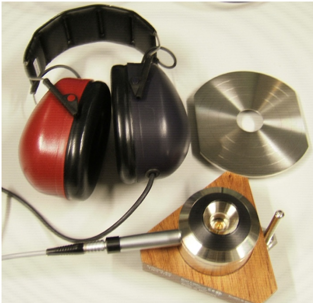
Audiometriekopfhörer mit Ohrkuppler und Mikrofon zur Kalibrierung
