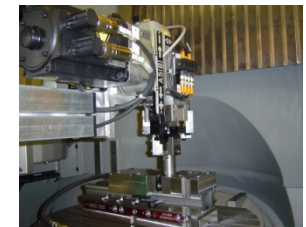
Bauteilübergabe an CNC - Fräsmaschine
