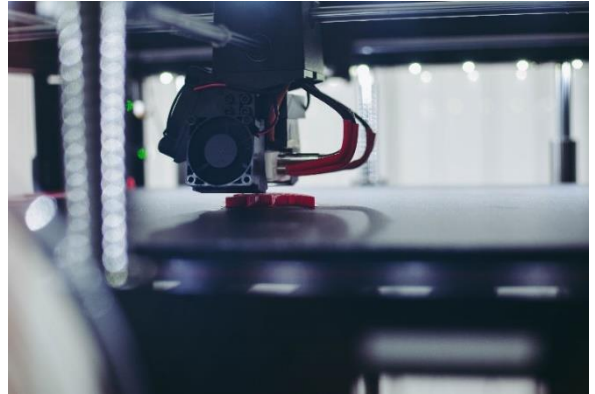
Abbildung 1: 3D-Druckverfahren (FFF) am Technologie Campus Hutthurm mit dem Raise3D Pro2 Quelle: Technologie Campus Hutthurm
