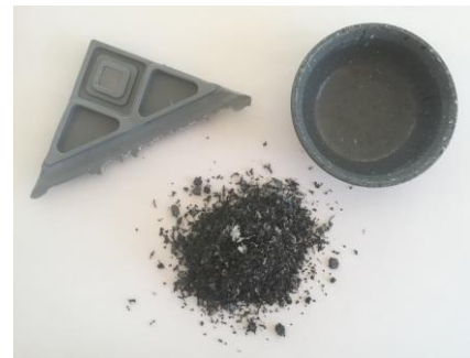
Abbildung 1: Kunststoffgemenge-Schüttgut mit Aluminiumpartikeln und daraus direkt prozessierte Demonstrator-Bauteile
